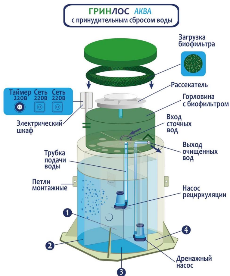
Рисунок 4. Схема модели с принудительным сбросом сточных вод и низким корпусом
