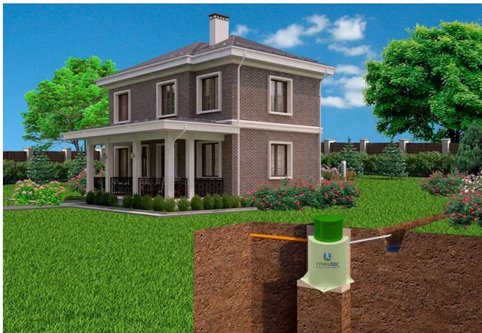
Рисунок 16. Монтаж с принудительным отводом сточных вод в дренажную канаву (Модели с низким корпусом)
